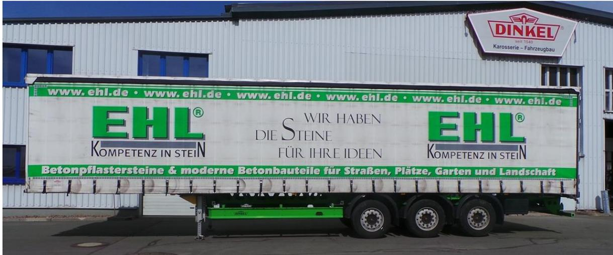
gebrauchter DINKEL – Sattelaufleger in Dreiachsausführung Typ DSAPP 39000 – in **Superleichtbauweise** mit Spanschiebeplanenaufbau, Schieberverdeck, Portaltüren, **Mitnahmestaplerhalterung für Stapler mit starren Rädern**, gebaut nach Code XL
