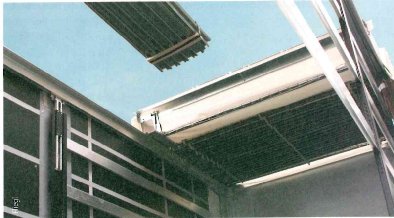
Neu bei Fliegl: Integralverschluss „I-Lock“ am Heckportal, jetzt in den Fahrzeugrahmen integriert und ohne Gegenhalter; beim Blitz Verdeck setzen die Thüringer auf hochwertigen Federstahl, erreichen eine verringerte Paketbreite, außerdem schnelles, komfortables Handling ohne Materialermüdung
