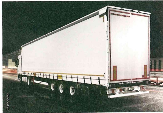
Bis zu 200 Kilo spart der Power Curtain laut Hersteller Schmitz Cargobull gegenüber konventionellen Pendanten; Der Kässbohrer Mega Curtainsider (rechts) ist mit 90 mm-Hals bestückt, die Aufsattelhöhe beträgt 950 mm, die Innenhöhe 2950 mm
