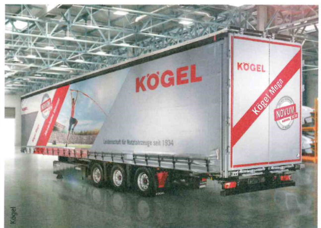
Bei Krone schätzen die Kunden die Mischung aus Kombizurrgurten und Sperrbalken; für das Schiebeplanensystem des Kögel Mega kommt vorne ein Umlenkhebel, hinten eine Ratsche zum Einsatz, das System der Burtenbacher besteht aus einer mit Mini-Rungen verstärkten Plane
