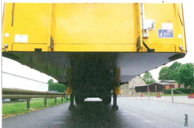
Gegen Verhaken komplett dicht: Dinkels innovative Halskonstruktion in Wabentechnik ist auch für Punktlasten als Sondervariante erhältlich. Die Plane am CITO-Schnellöffnungssystem kann heck- oder stirnwanseitig gelöst, entriegelt, verschoben und wieder verspannt werden
