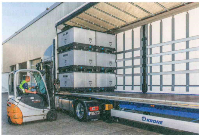
Auch Krone setzt zum Beladen auf praxistaugliche Hubdächer; Genügend große Langlöcher am Außenrahmen des Kässbohrer KSC M lassen die Zurrhaken nicht mehr am Profil aufstehen
