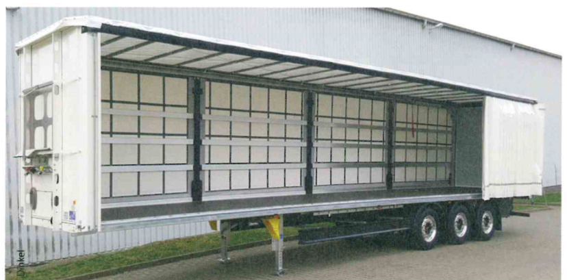
Gegen Verhaken komplett dicht: Dinkels innovative Halskonstruktion in Wabentechnik ist auch für Punktlasten als Sondervariante erhältlich. Die Plane am CITO-Schnellöffnungssystem kann heck- oder stirnwanseitig gelöst, entriegelt, verschoben und wieder verspannt werden
