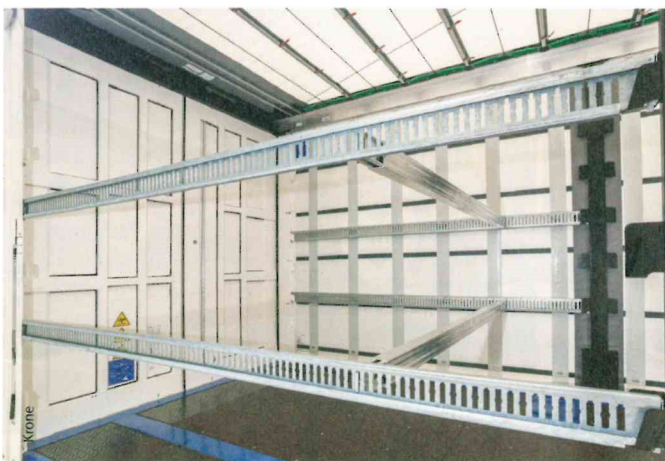
Bei Krone schätzen die Kunden die Mischung aus Kombizurrgurten und Sperrbalken; für das Schiebeplanensystem des Kögel Mega kommt vorne ein Umlenkhebel, hinten eine Ratsche zum Einsatz, das System der Burtenbacher besteht aus einer mit Mini-Rungen verstärkten Plane
