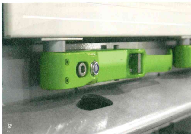
Neu bei Fliegl: Integralverschluss „I-Lock“ am Heckportal, jetzt in den Fahrzeugrahmen integriert und ohne Gegenhalter; beim Blitz Verdeck setzen die Thüringer auf hochwertigen Federstahl, erreichen eine verringerte Paketbreite, außerdem schnelles, komfortables Handling ohne Materialermüdung
