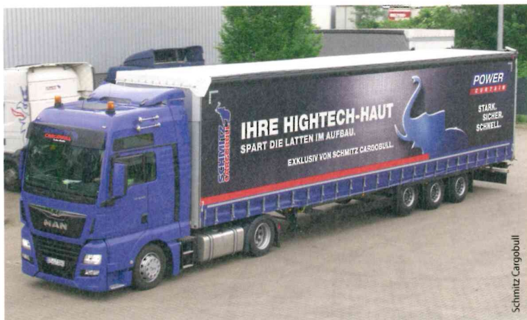
Bis zu 200 Kilo spart der Power Curtain laut Hersteller Schmitz Cargobull gegenüber konventionellen Pendanten; Der Kässbohrer Mega Curtainsider (rechts) ist mit 90 mm-Hals bestückt, die Aufsattelhöhe beträgt 950 mm, die Innenhöhe 2950 mm
